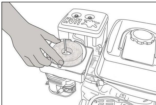
Рис. 43. Установка воздушного фильтра
